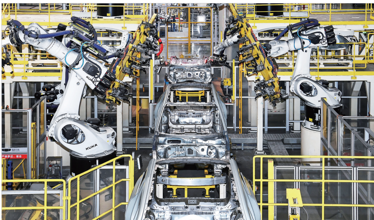
2月26日在吉利汽车宝鸡制造基地焊装厂拍摄的自动化焊接线。
