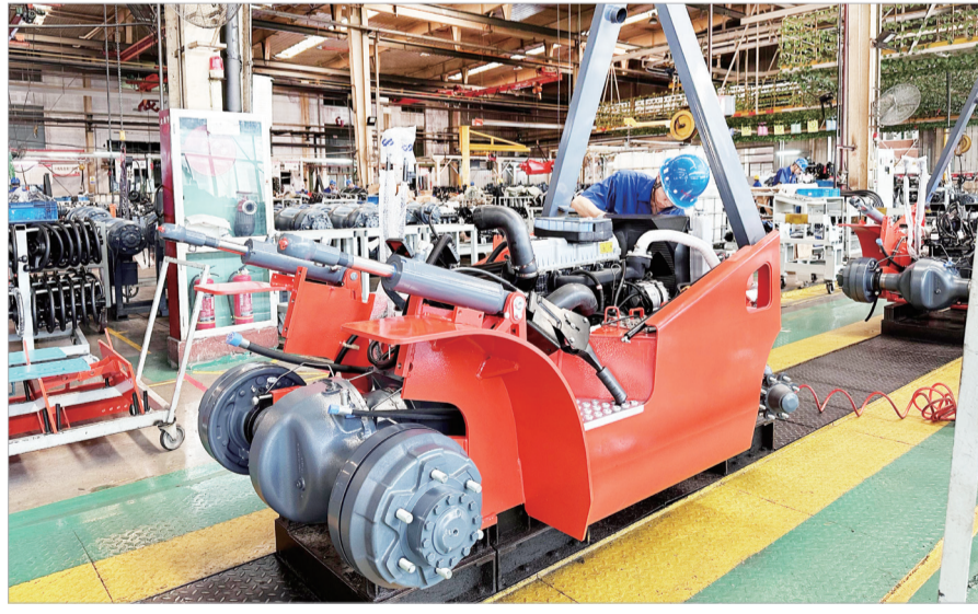
宝鸡合力叉车有限公司叉车整机组装生产线（资料图）
