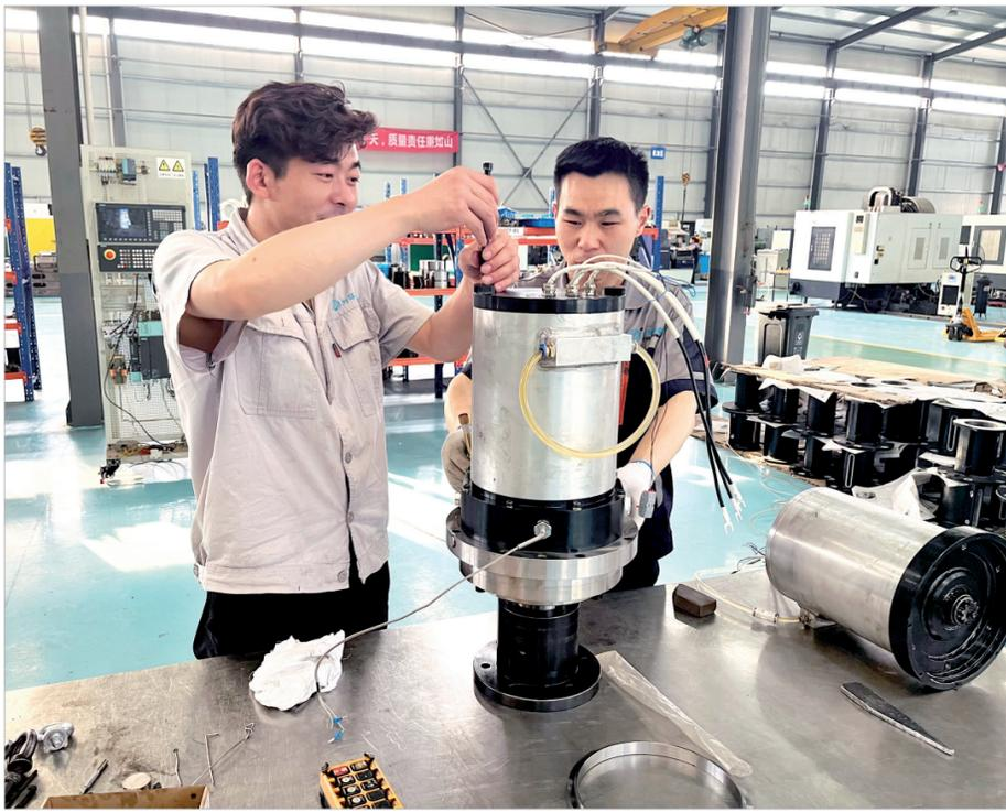
本报讯(记者 郑晔)“我们最新研发的风电系列偏航减速器,正在进行动态加载试验,预计7月就能小批量试制生产。”近日,记者来到位于渭滨区的陕西六环智能装备科技有限公司(以下简称“六环智能”),工人正在对一台偏航减速器进行性能检测(见上图)。据了解,经过一年多的研发,六环智能在风电系列减速器上取得了新突破。
