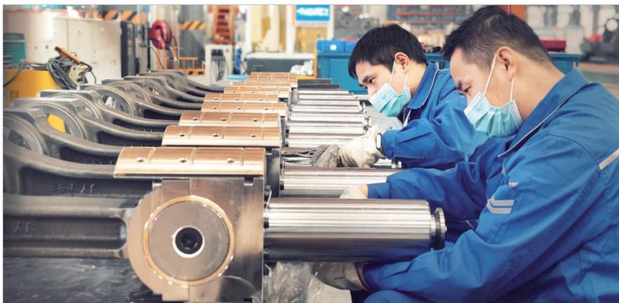
工人在组装压裂泵十字头连杆总成
