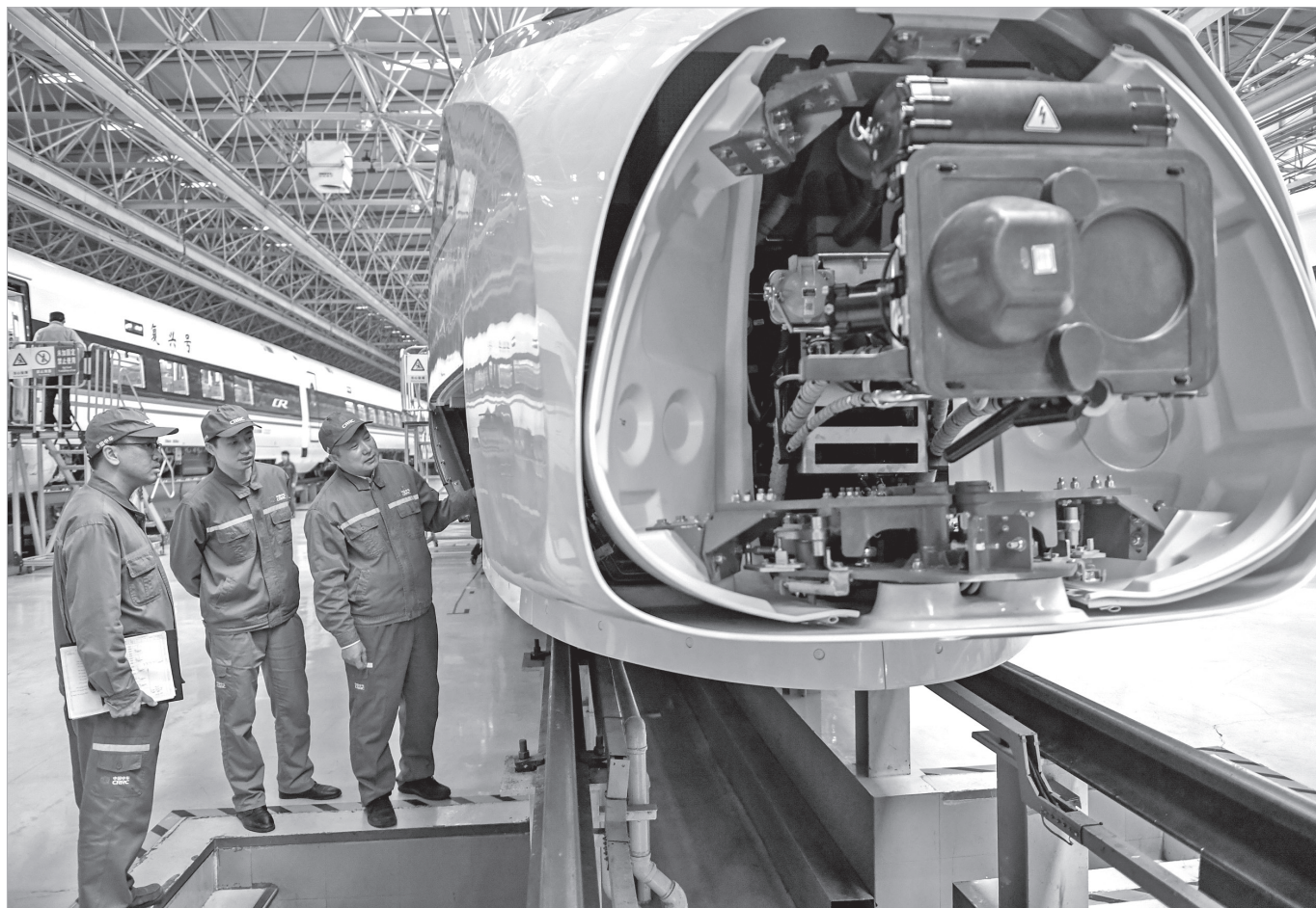
在吉林省长春市中车长春轨道客车股份有限公司高速动车组制造中心调试车间，首席技能专家罗昭强（右一）与同事检查复兴号高铁列车的电气系统（2020年11月25日摄）。 新华社发
