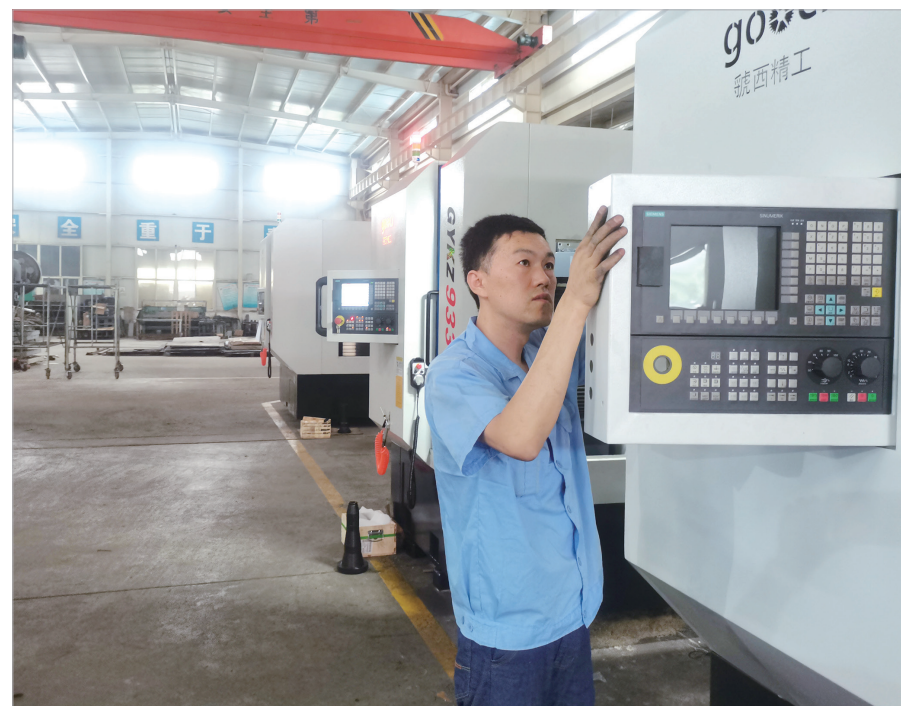
工人调试数控齿轮倒角机床
