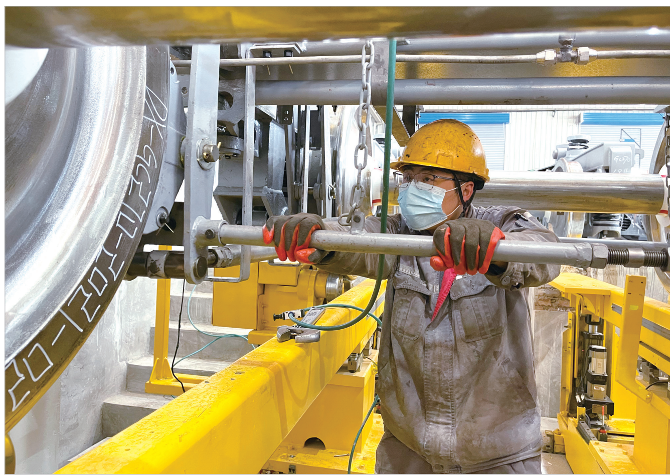
机加车间工人在对转向架制动性能进行调试
