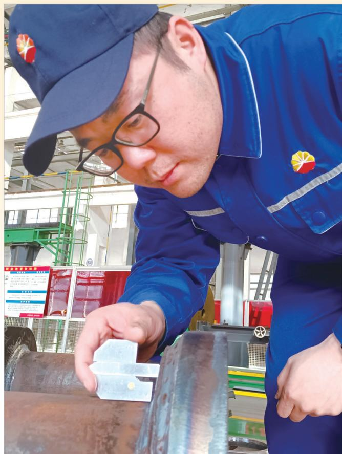
商杰在检测焊缝高度
