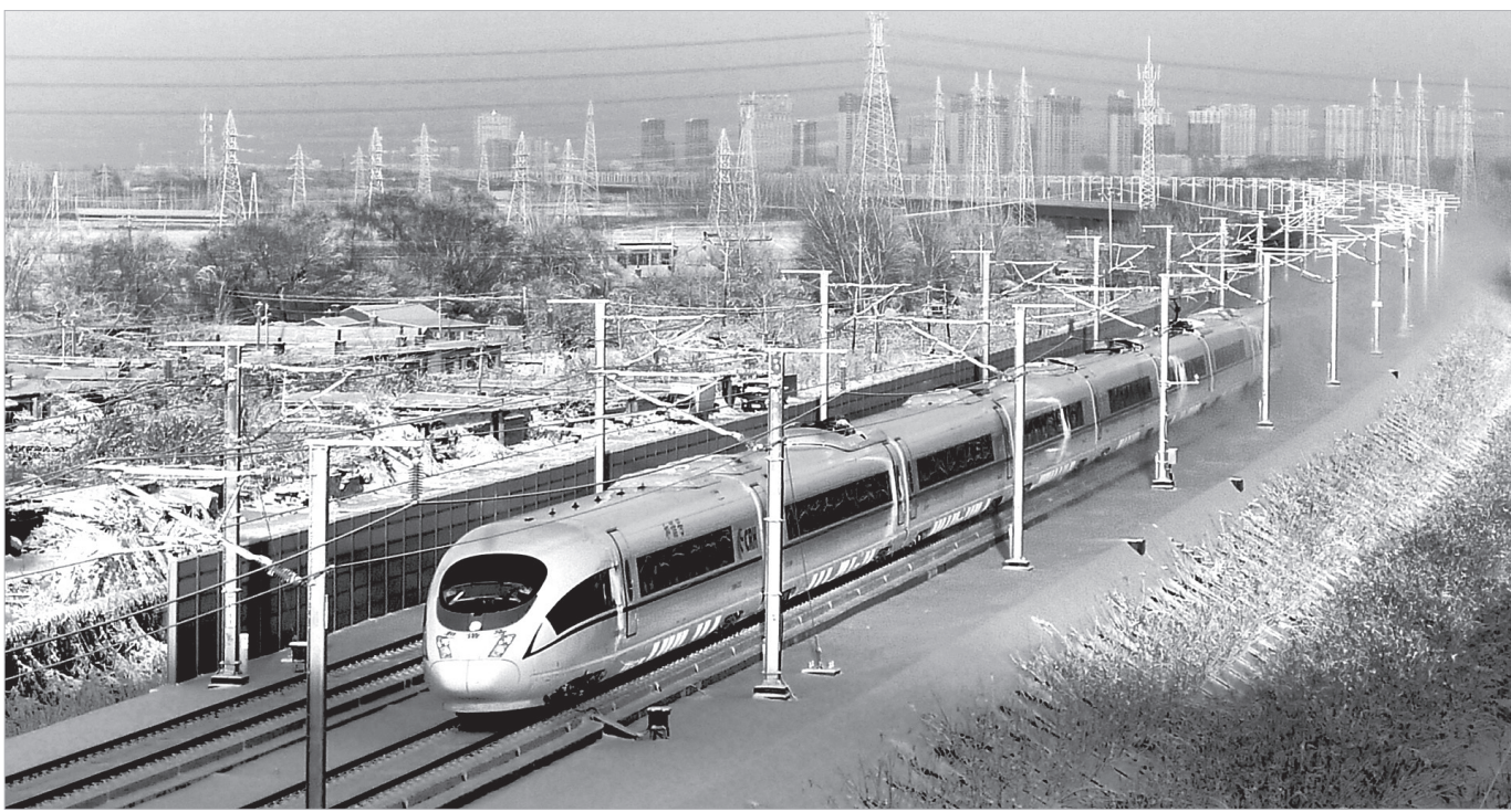
高铁电气为哈大高铁牵引供电系统提供了接触网供电设备
