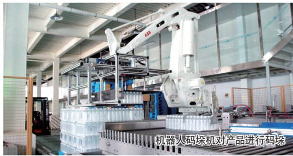
机器人码垛机对产品进行码垛
