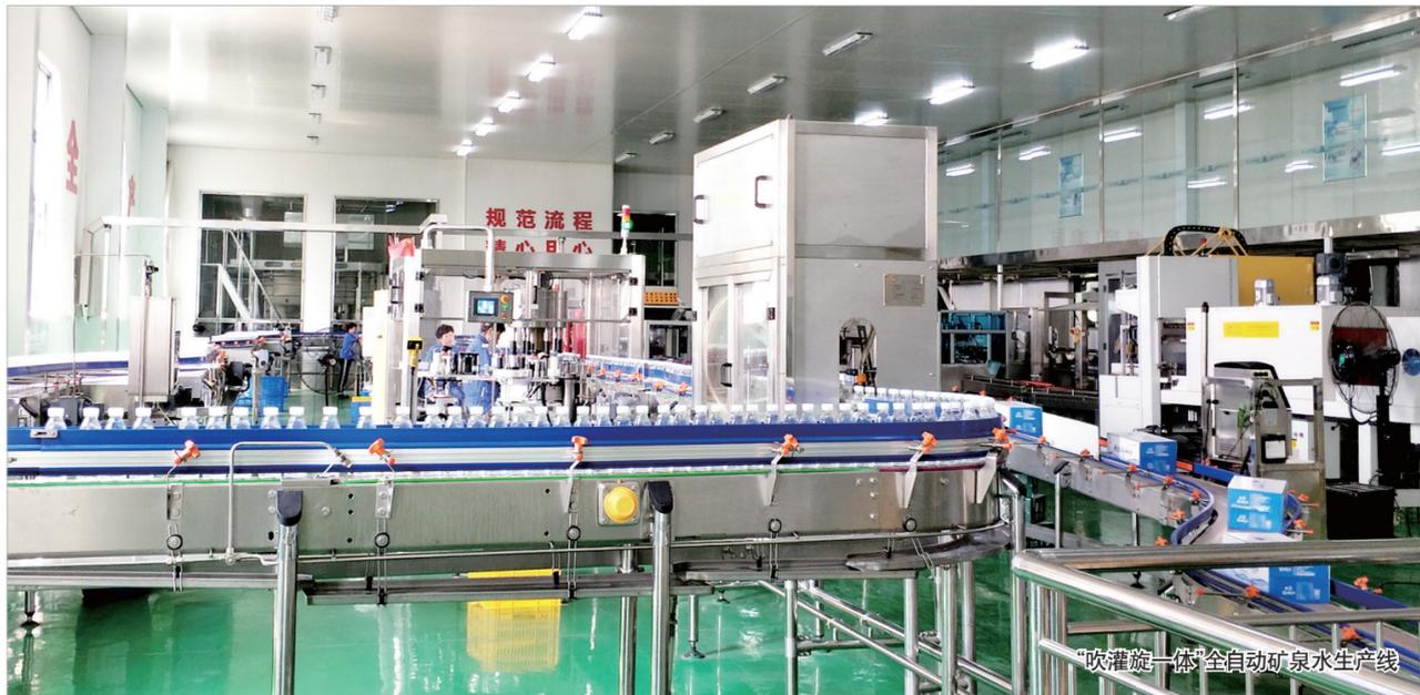
“吹灌旋一体”全自动矿泉水生产线
