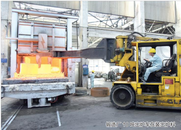
锻造厂10吨出炉车在装出炉料
