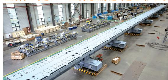
本报讯 9月24日,笔者从 中铁宝桥集团获悉,该公司自主 研发的世界第一组时速 600 公里 高速磁浮道岔,近日顺利通过中 车青岛四方机车车辆股份有限公 司组织的出厂验收(见上图),准
