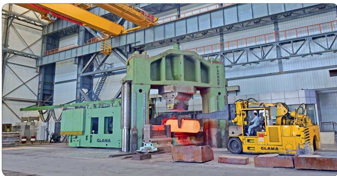
8月11日9时,在陕西有色金属集团宝钛集团锻造厂,万吨自由锻压机正开足马力锻压钛锭。当日,记者一走进热加工车间,股热浪就扑面而来,而工人们却坚守在岗位,紧张有序地工作着。据了解,宝钛集团在做好疫情防控的前提下全力促生产,其主要产品钛及钛合金,日产能达40吨。“我们想方设法提效率,开足马力搞生产,员工三班倒、设备24小时不停歇,奋力挽回疫情造成的损失。”宝钛集团锻造厂副厂长孙小勇说。记者了解到,今年以来,尽管宝钛集团的民品、出口订货量都有所下降,但新品订货量实现了增长;加之企业对设备进行了更新升级,大大提高了生产效率,产值、利润不减反增。上半年宝钛集团工业总产值同比增长4%,营业收入同比增长8.7%,利润总额同比增长213.7%。7月份以来,宝钛集团开足马力促生产,奋力向完成全年目标任务迈进。 本报记者 符雅琦 摄
