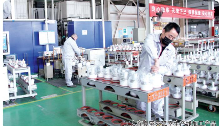
工人在真空灭弧室生产线加工产品
