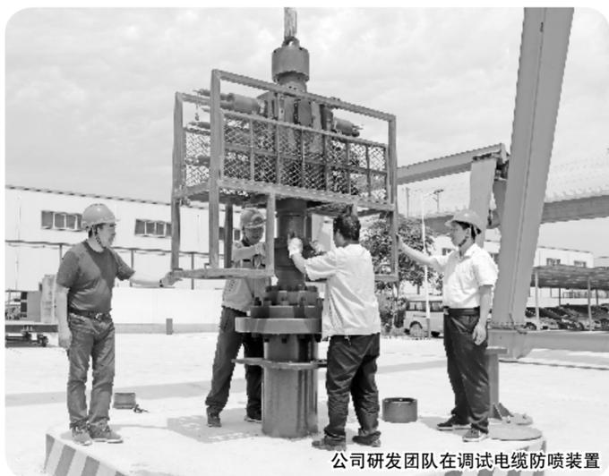
公司研发团队在调试电缆防喷装置
