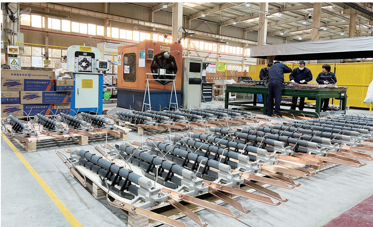
公司为马来西亚东海岸铁路项目生产的绝缘器
