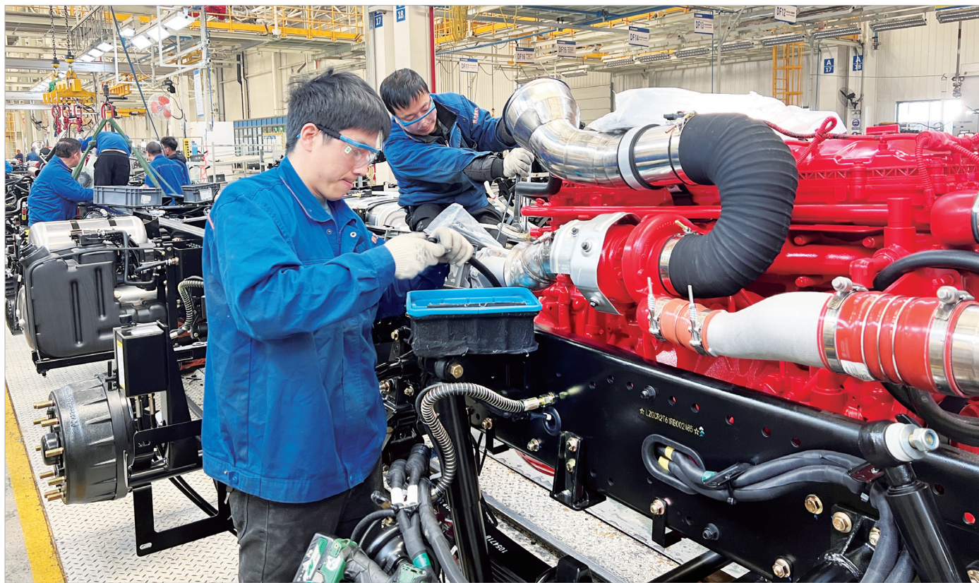
陕汽商用车组装车间，工人在安装动力线路。
