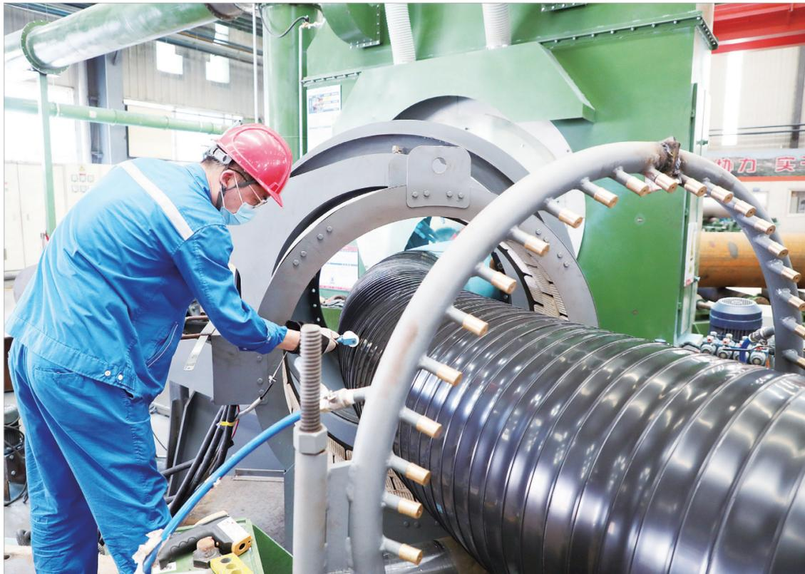
工人正在生产直径610毫米聚乙烯复合带防腐弯管
