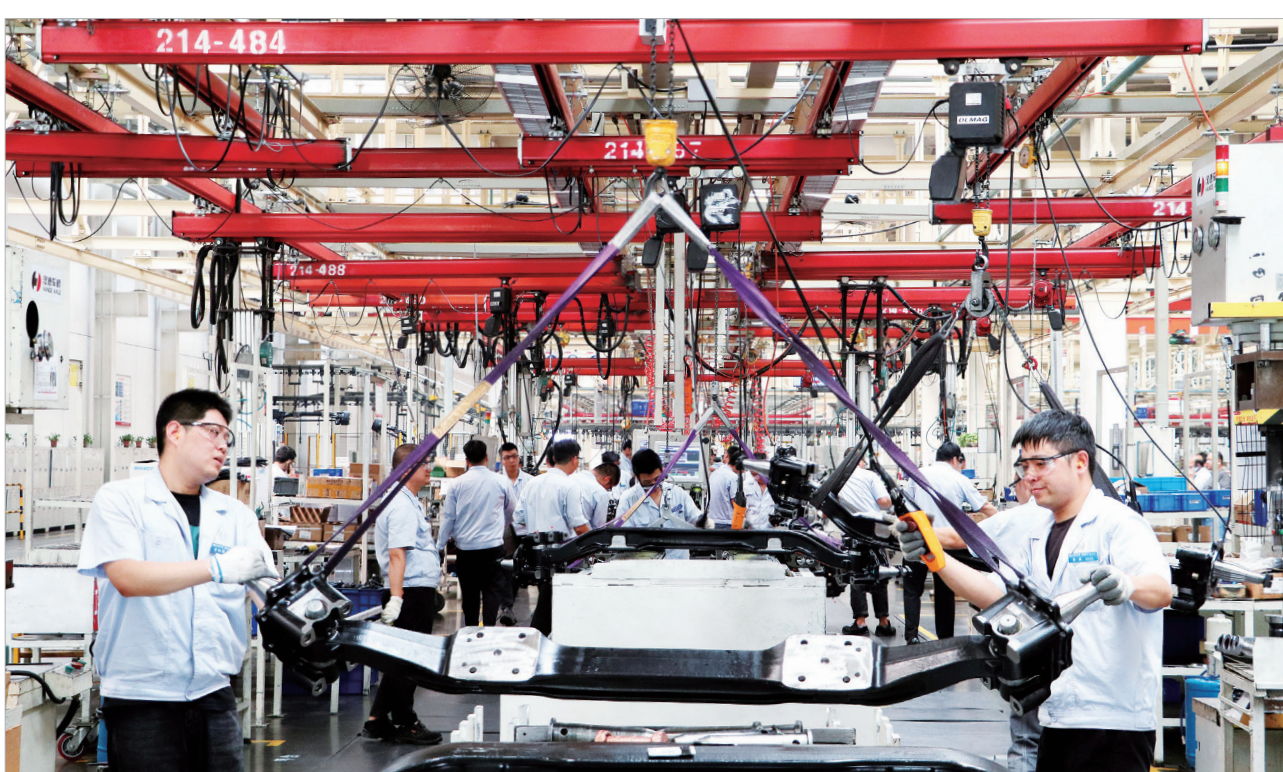
工人在加工车桥部分零件
