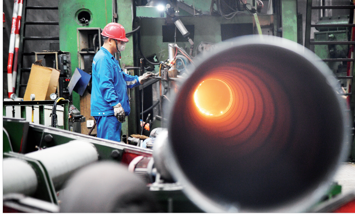
工人在生产20%掺氢比管线钢管
