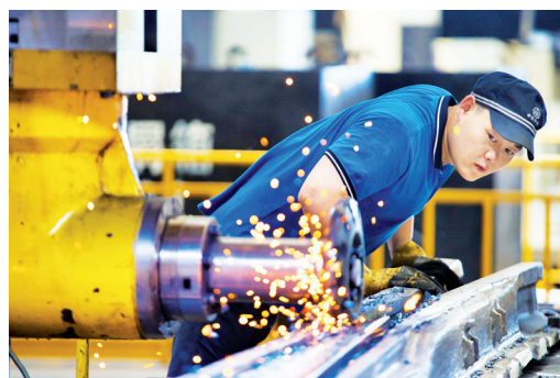
中铁宝桥职工对辙叉进行机加工处理
