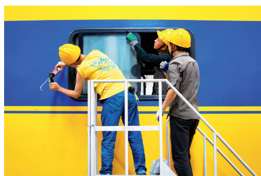
宝鸡中车时代工人安装接触网检修作业车车窗
