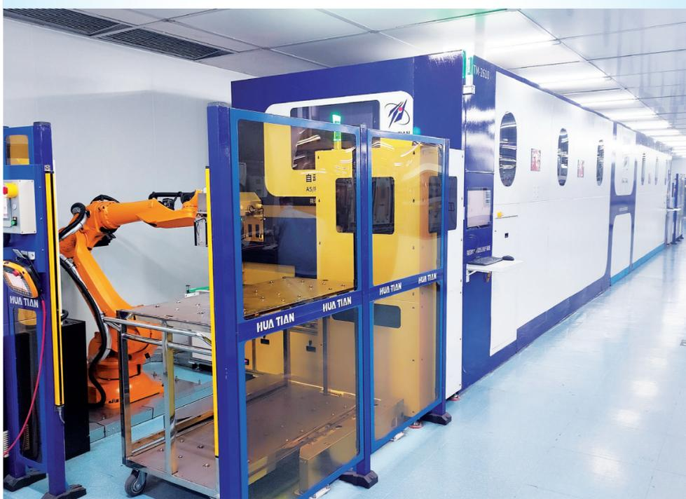
本报讯(记者 邵菲菲)日前，记者从华天科技(宝鸡)有限公司获悉，该公司今年成功研发出集成电路封测产品——智能氮气仓储系统(见上图)，填补了国内市场空白，实现了集成电路封测产品精准存取、远程配送自动化。
