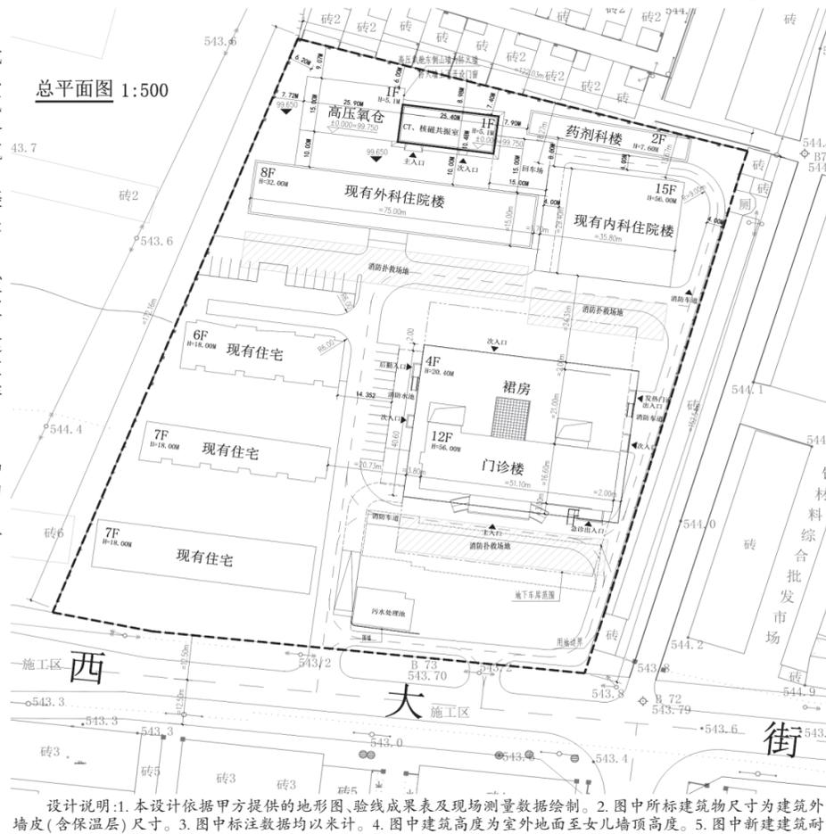
设计说明:1.本设计依据甲方提供的地形图、验线成果表及现场测量数据绘制。2.图中所标建筑物尺寸为建筑外墙皮(含保温层)尺寸。3.图中标注数据均以米计。4.图中建筑高度为室外地面至女儿墙顶高度。5.图中新建建筑耐火等级为二级,已建高压氧舱、外科住院楼、药剂科楼耐火等级均为二级。
