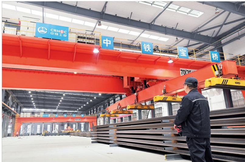
本报讯(记者 李依涵)3月1日，在中铁宝桥集团道岔分公司新改造的生产车间内，一根钢轨原材料被高强磁力吸盘缓缓送至加工平台，快速完成了自动锯切、自动钻孔等工序后，进入下一加工流程，这标志着中铁宝桥百米钢轨生产线正式投产(见左图)。
