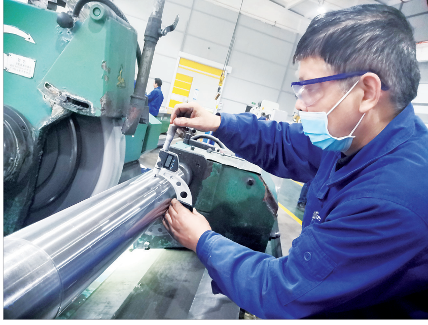
陕西北方风力机电有限责任公司，工人在精密机床上加工风电机组轴。
