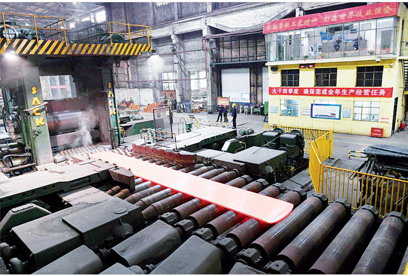
宝钛集团宽厚板材料公司3.3米四辊可逆式热轧机组生产线正在轧制钛钢复合板（受访者供图）
