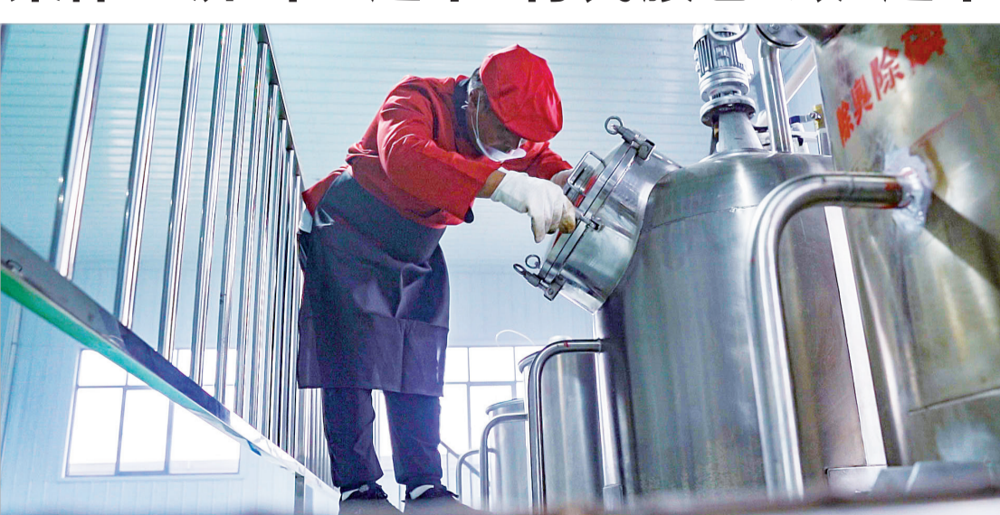
工人在检查沉淀罐
