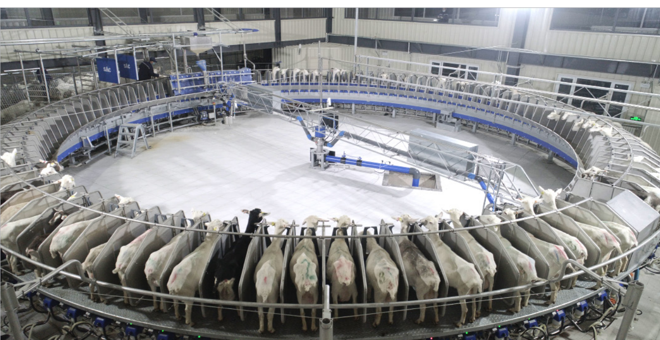
正大现代化羊舍中的转盘式挤奶器
