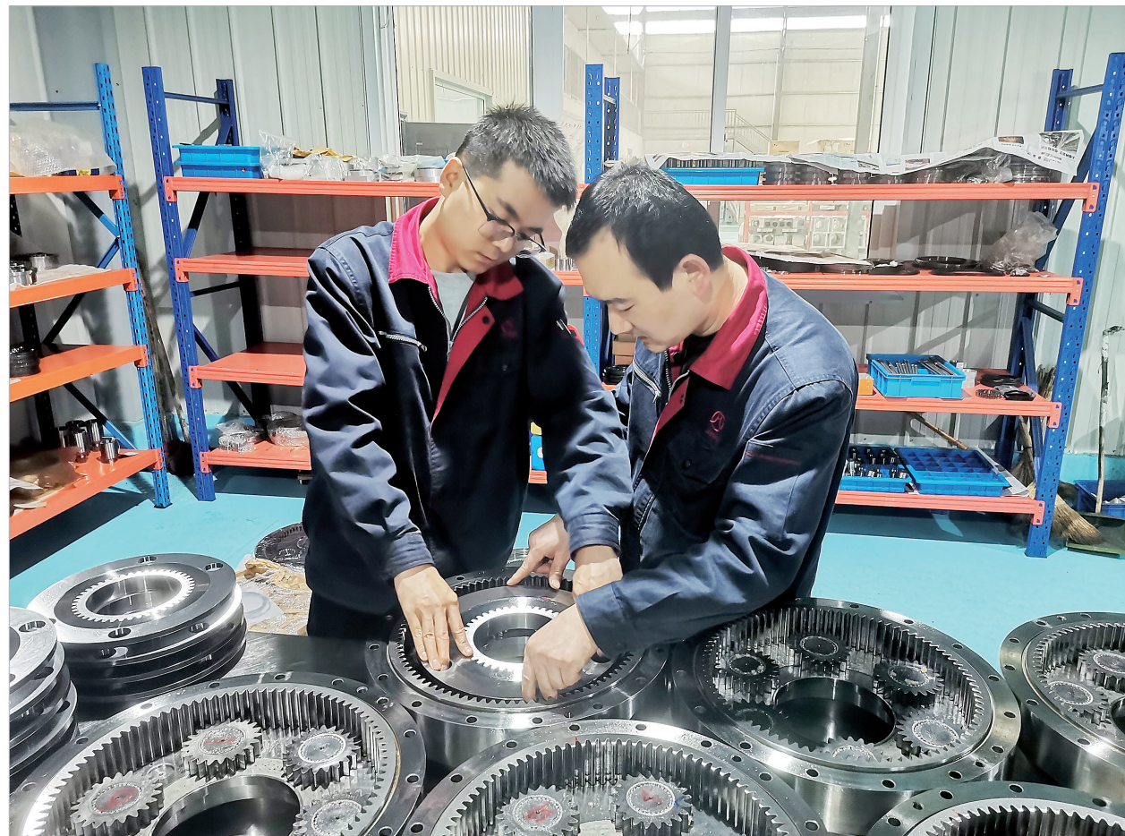
工人正在组装500CA减速器
