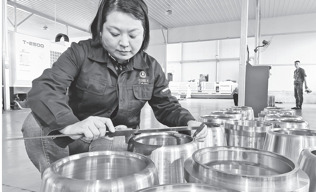
园区企业宝鸡瑞诚众邦机械加工有限公司检验人员进行尺寸测量
