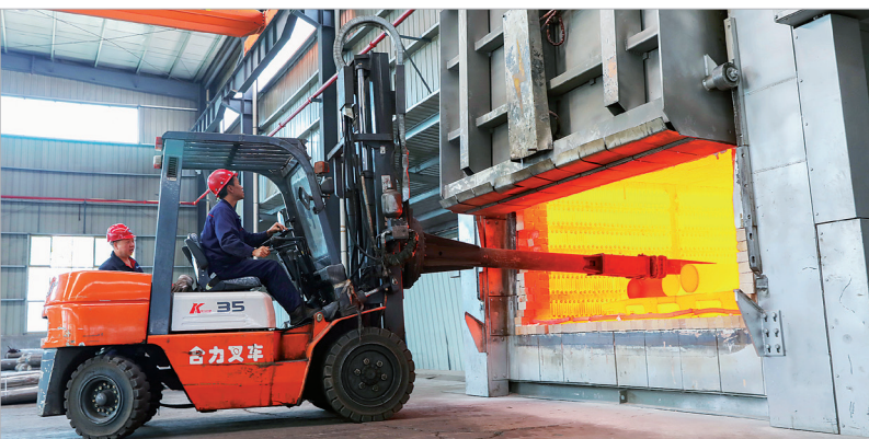
出炉车将钛棒从加热炉中取出
