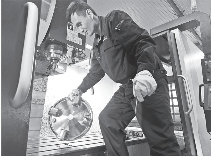
加工中心操作手在装夹加工件
