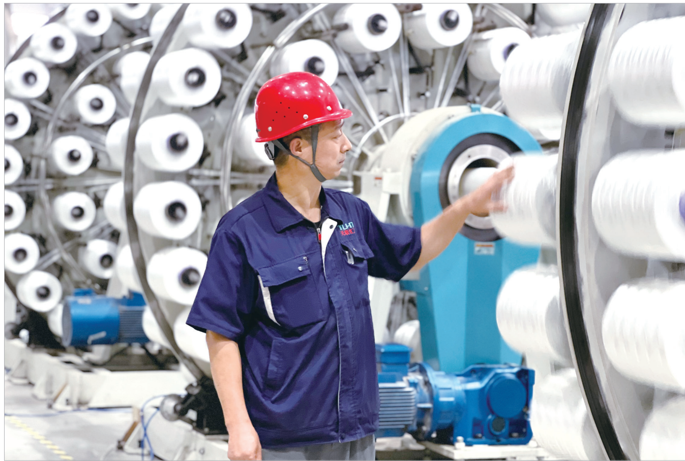
工人正在进行增强层的缠绕检查
