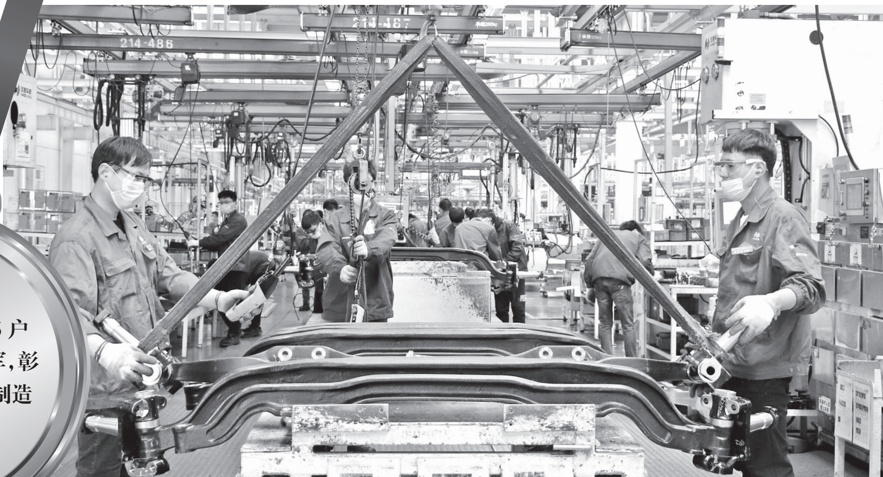
陕西汉德车桥有限公司生产线上，工人在吊装车桥。石宝军摄
