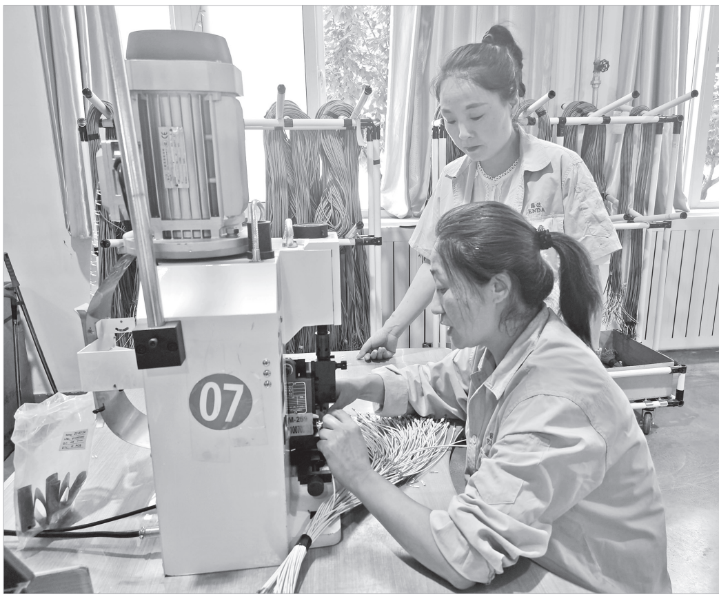
陇县恩达车用线束生产线项目车间，工人在加工汽车线束。
