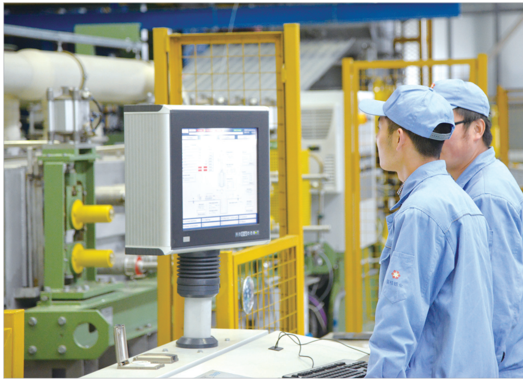
国核宝钛铝业股份公司工人查看带材连续退火炉作业
