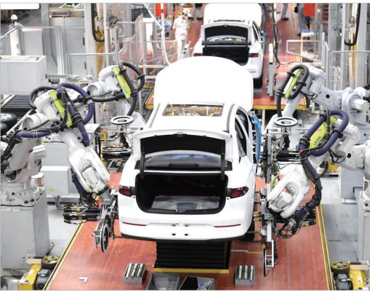
在广汽埃安新能源汽车股份有限公司总装生产线，机器人手臂在安装汽车轮胎。
