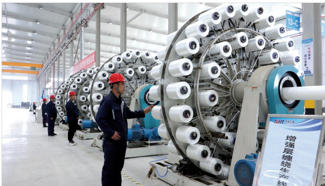
宝鸡高新区 RTP 柔性复合高压输送管项目生产线 石宝军摄
