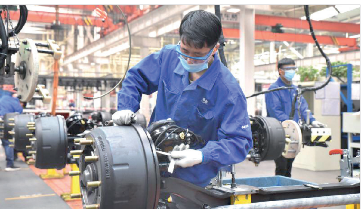
汉德车桥中轻卡车桥工厂内,工人在装配前轴。
