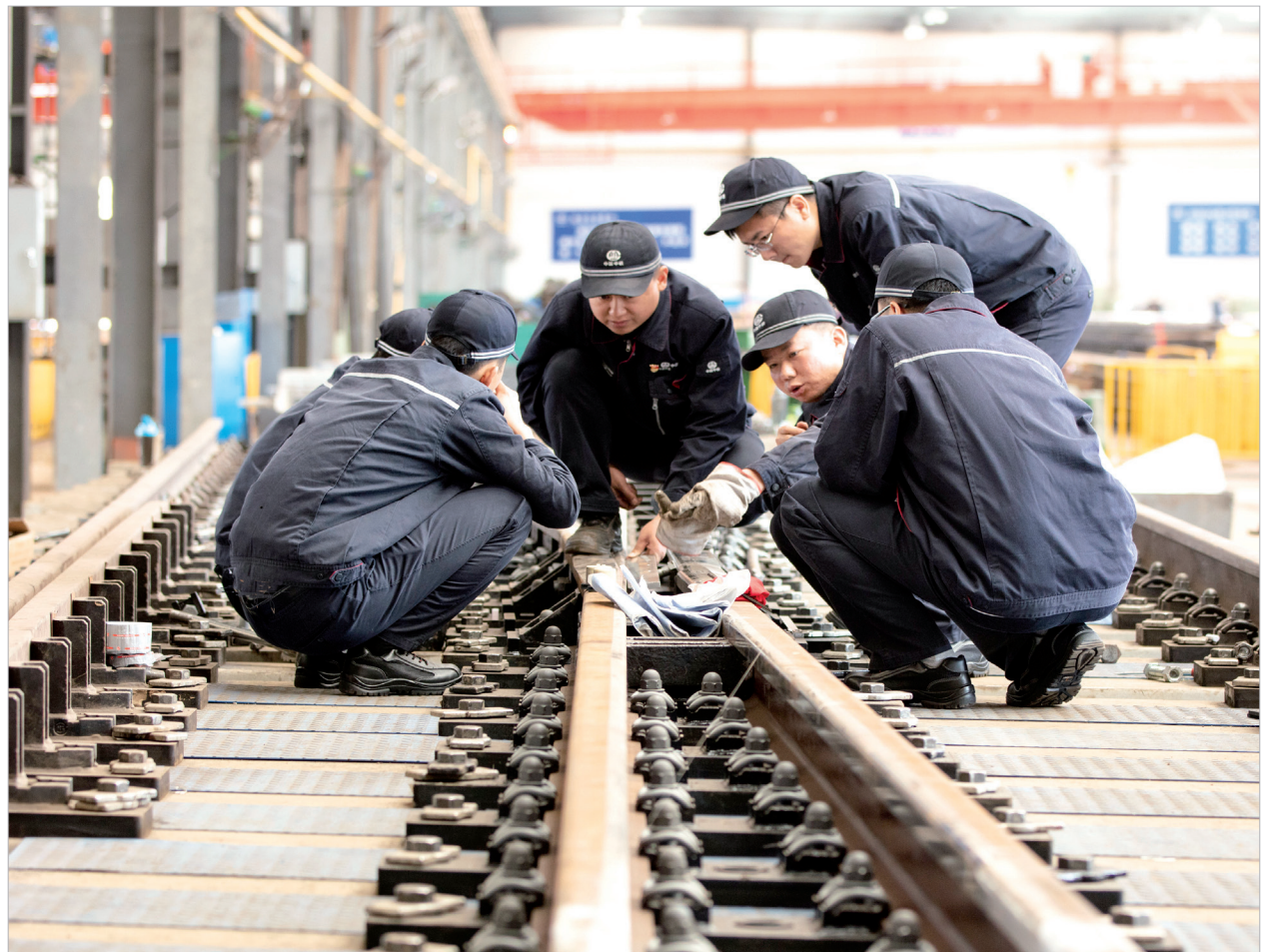
中铁宝桥宝鸡事业部道岔分公司职工在试制试铺新型铁路道岔 蒋晓强 摄
