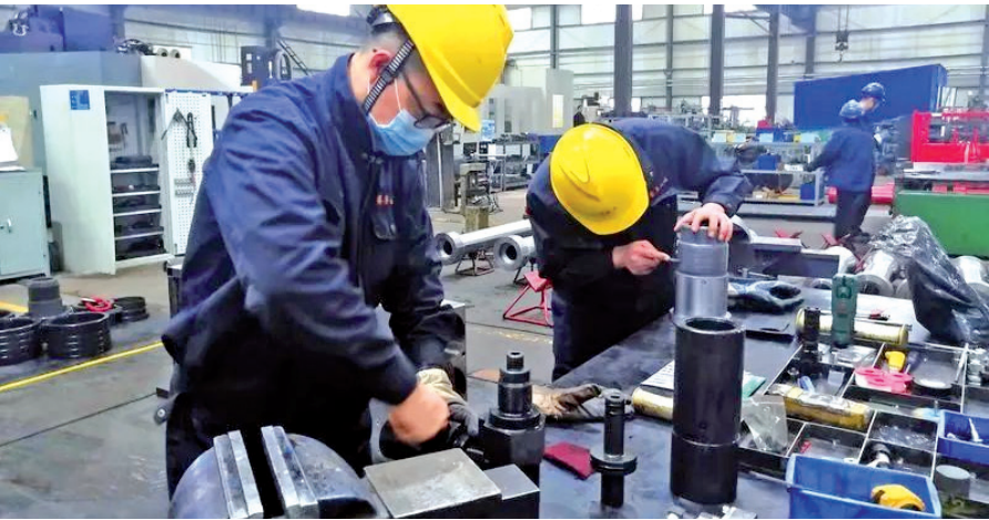
宝鸡赛孚石油机械公司工人制造和组装防喷装置
