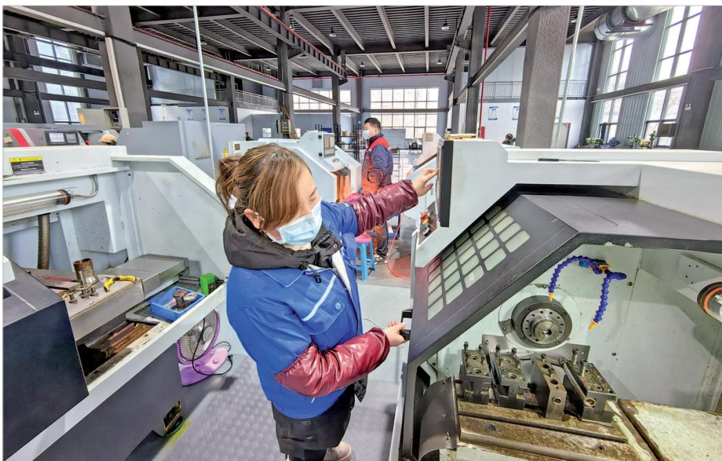
华天奕新材料科技有限公司工人在加工高精度钛合金螺丝
