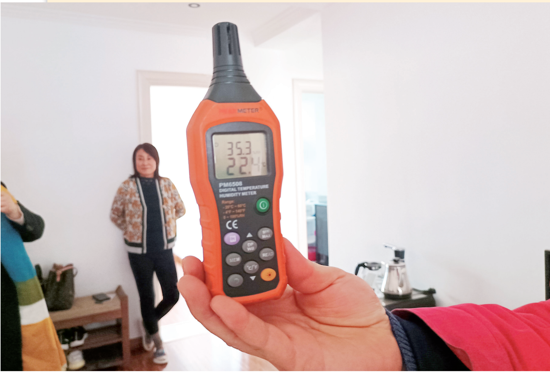
市区陈仓园一区经过老旧小区改造后,旧房子加装了保温层,居民家中的暖气温度达到22.4°C。
