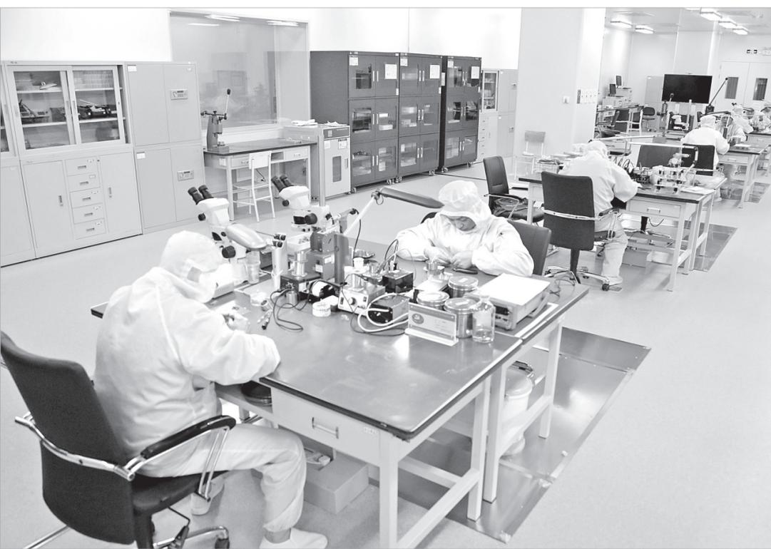
捷联事业部挠性陀螺组正在进行陀螺仪的装配工作
