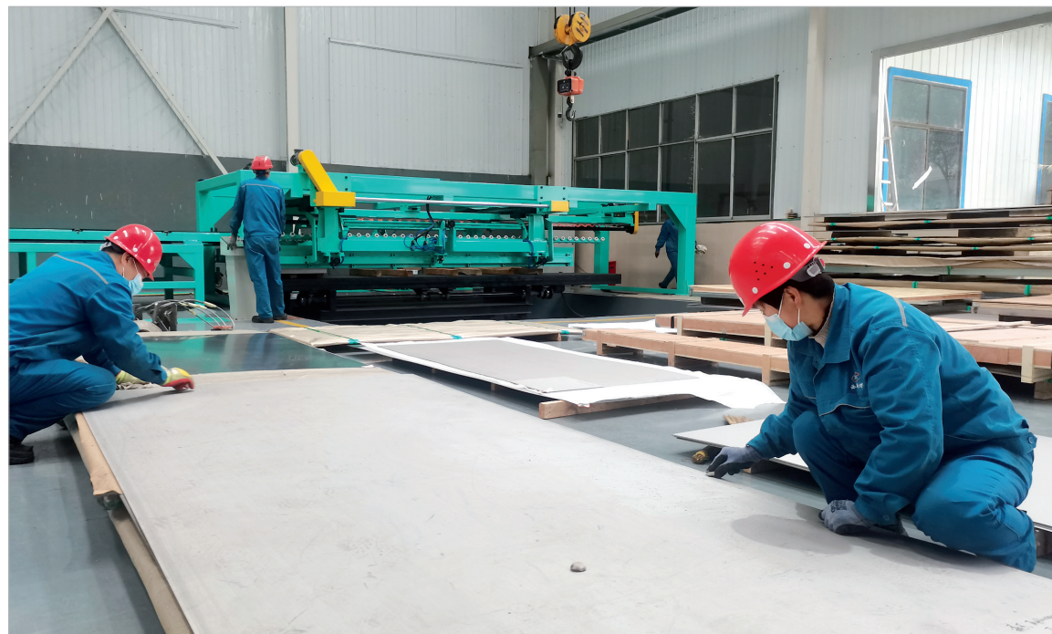
工人在检测钛板质量
