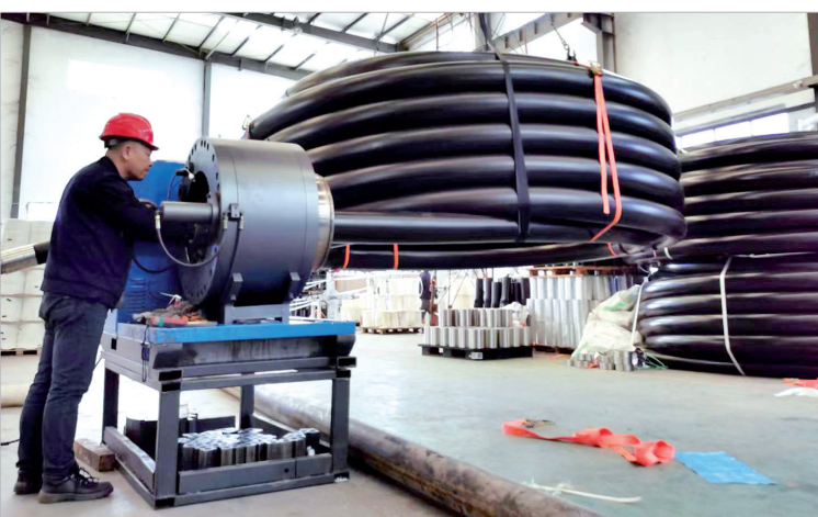
工人在给非金属连续复合管安装接头
