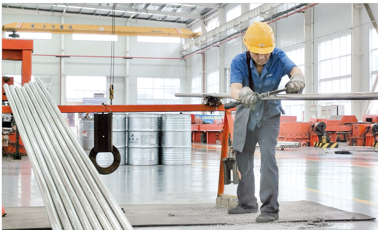
工人处理管材表面的细微瑕疵
