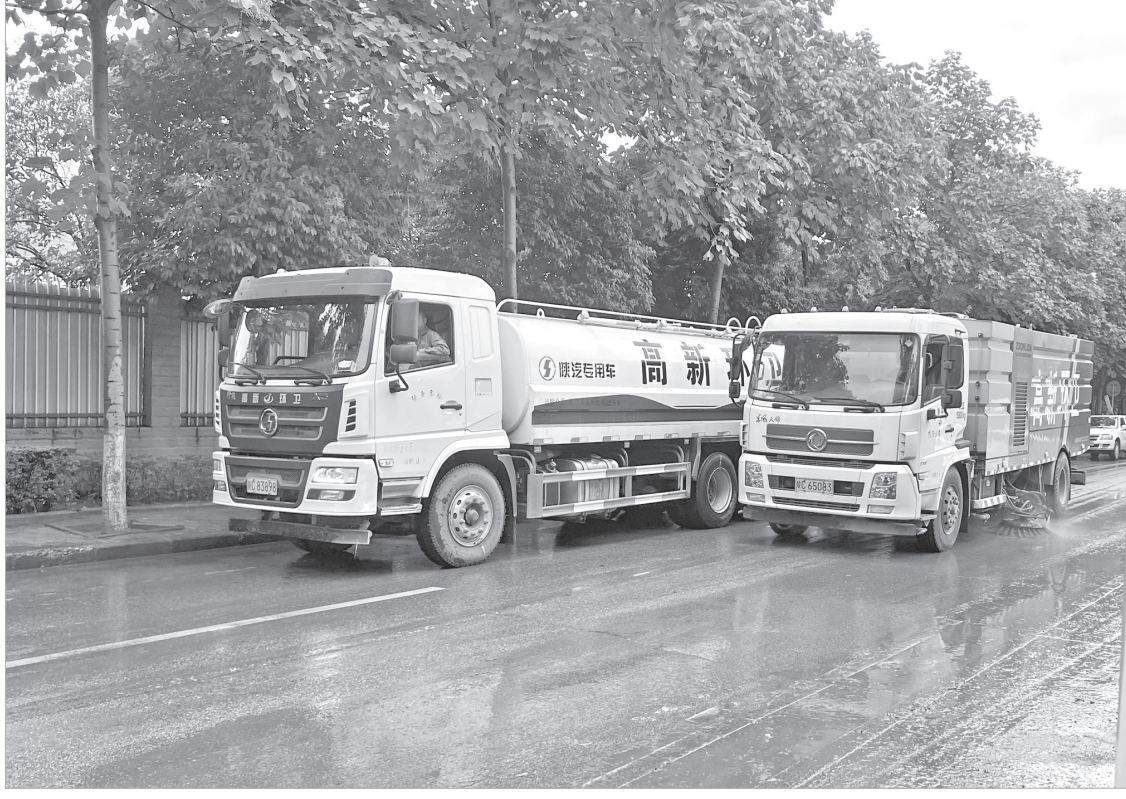
洗扫车、洒水车联合作业冲洗雨后淤泥
