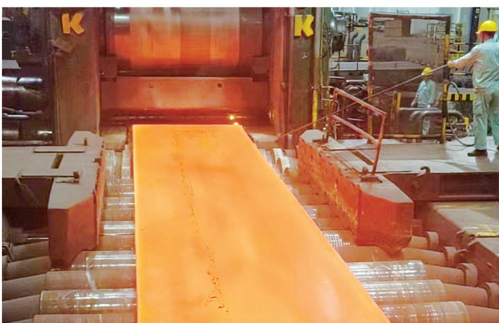
本报讯 日前，宝钛集团成功研制出单重8.7吨、规格为55×2200×15700毫米的1000兆帕级高强高韧钛合金板材（见上图），这是迄今为止国内生产的单重最大、长度最长的宽幅高强高韧钛合金厚板。
