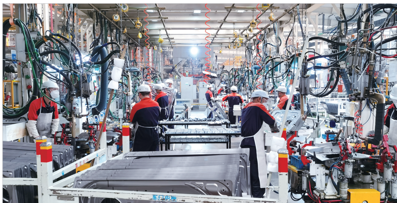
宝鸡吉利公司工人在流水线上定型车门内板 宋文君 摄
